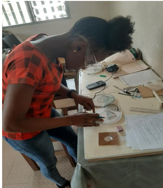
FEUJIO WOWO CARELE Master 1 en Génie Mécanique TP Optique : Mesure de l'indice de réfraction d'un prisme à l'aide d'une source laser
